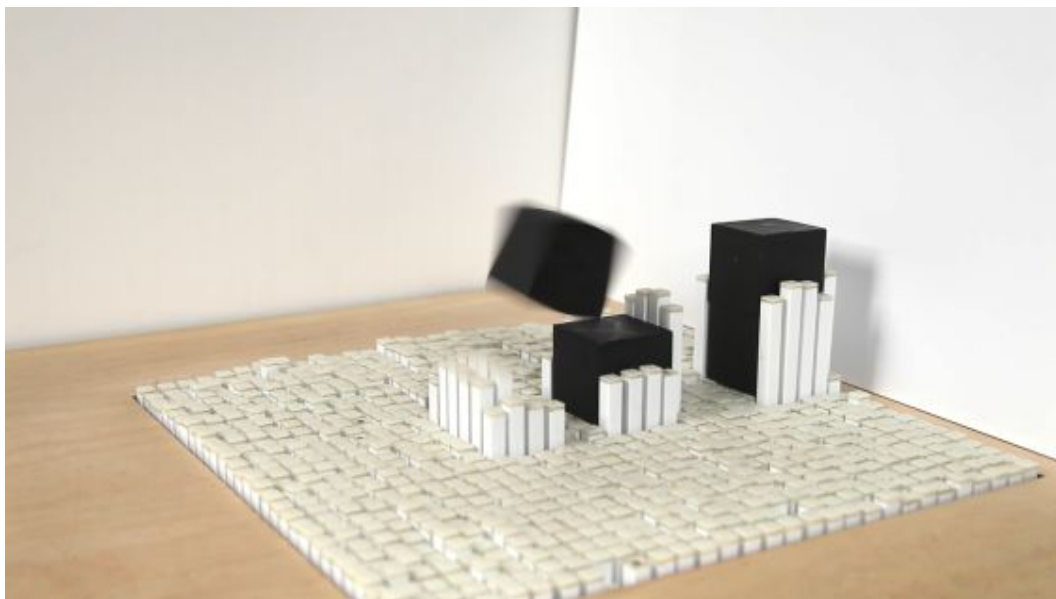
La alfombra inFORM impulsa un cubo por el aire para hacerlo aterrizar justo encima de otro. A la derecha se aprecian dos bloques ya apilados por este procedimiento. / © 2012 TANGIBLE MEDIA GROUP / MIT MEDIA LAB
